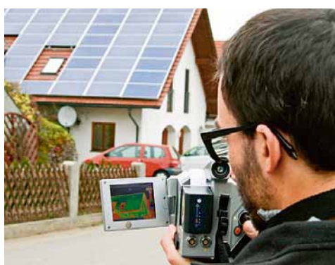
Bernhard Weinreich misst mit einem Thermografen eine Dachanlage. Links: Auch Drohnen werden vermehrt eingesetzt.
